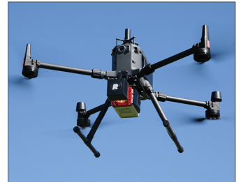
大疆 M300 RTK 无人机使用 RIEGL 300 集成套件搭载 miniVUX-SYS 系统
